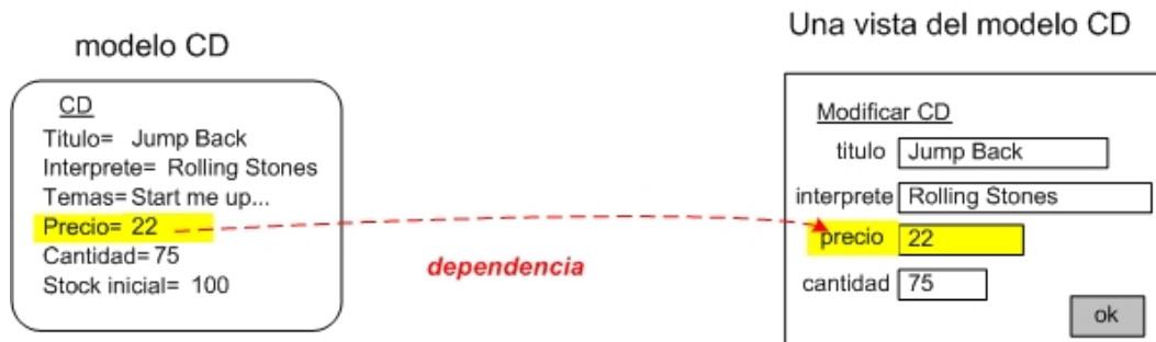
Figura 2.12- El campo de texto marcado depende del atributo precio formando un MVC a nivel componente
